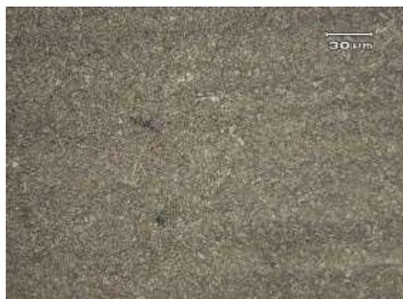
Figura 4: Microestrutura do aço4340
