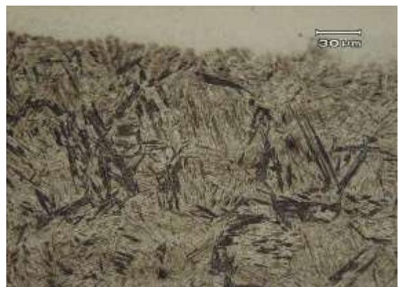
Figura 12: Interface solda/aço
