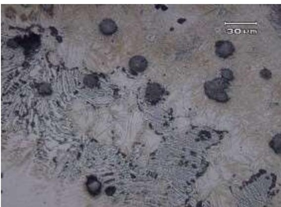
Figura 11: Interface solda/ferro fundido
