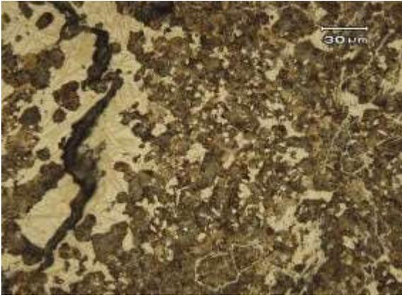
Figura 7: Trinca no ferro fundido
