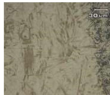
Figura 19: Interface solda/aço
