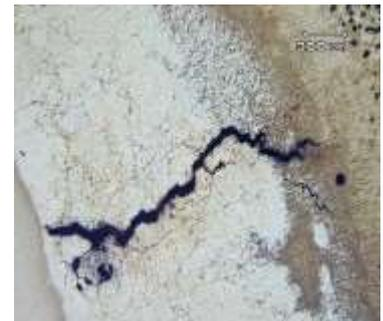
Figura 32: Trinca na solda
