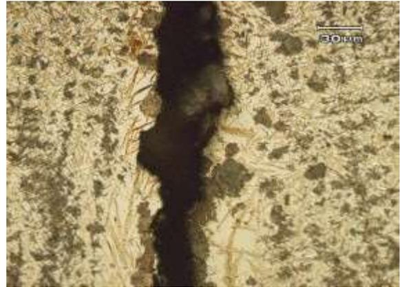
Figura 8: Trinca no ferro fundido
