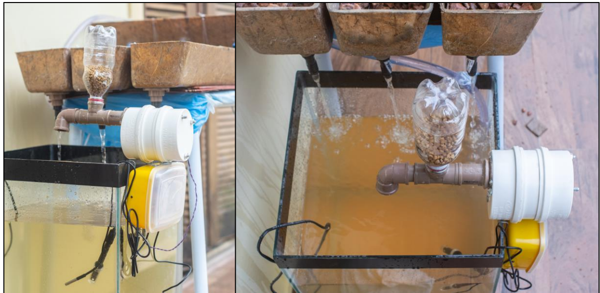
Figura 28: Vistas do alimentador completo montado no sistema de aquaponia para testes
