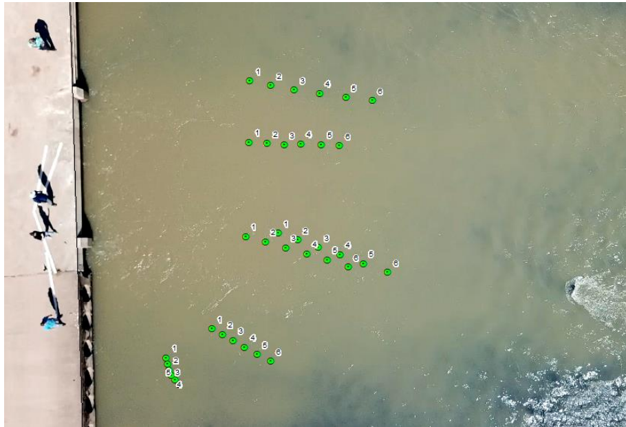
Figura 49. Resultados dos levantamentos utilizando laranjas.
