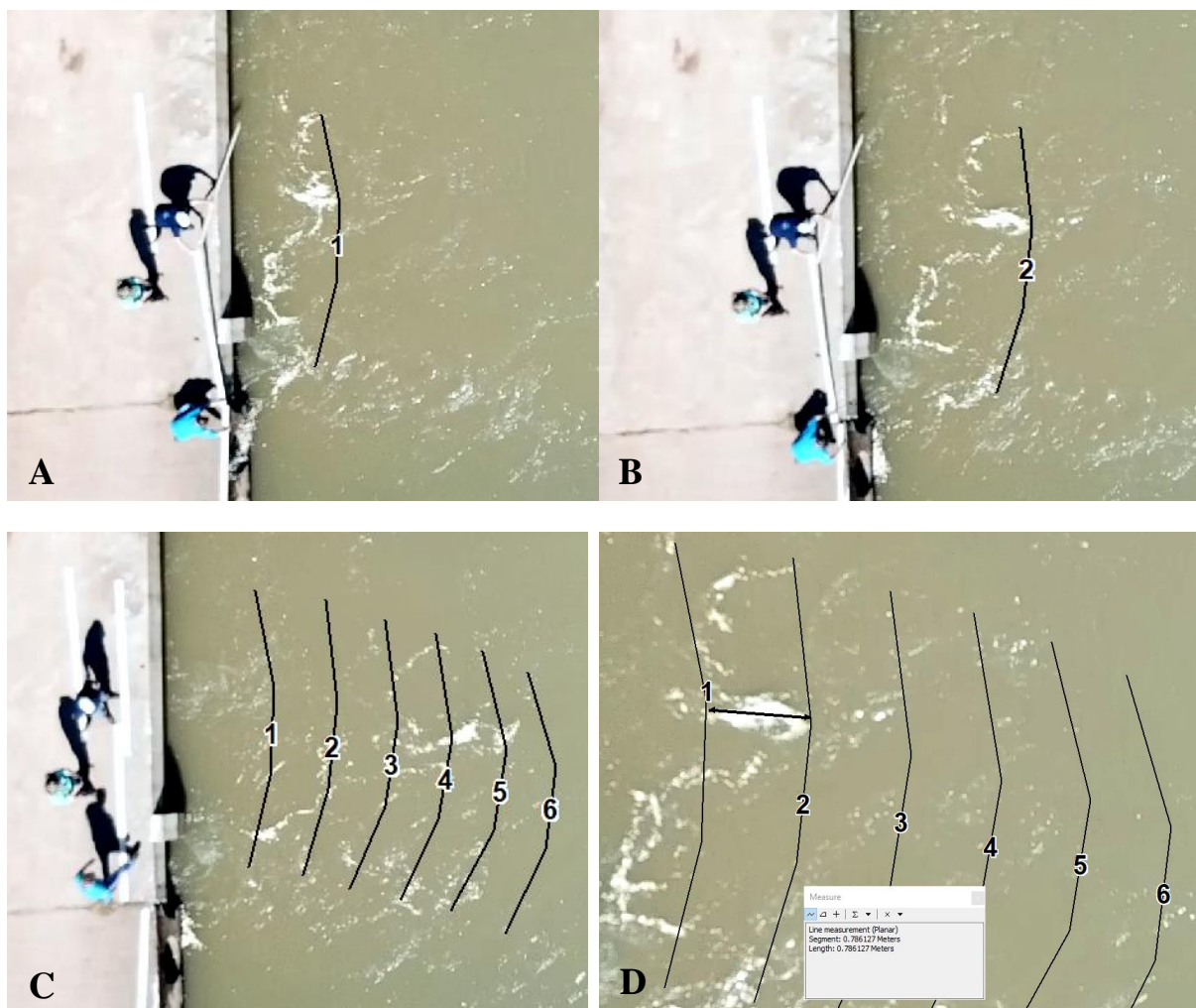
Figura 42: Procedimento de análise dos dados por meio de linhas com utilização de pipocas como traçador. Onde A: delimitação da linha na primeira imagem; B: delimitação da linha na segunda imagem; C: delimitação da linha na sexta imagem e representação das linhas demarcadas; e D: medição da distância entre duas linhas consecutivas junto ao centro.
