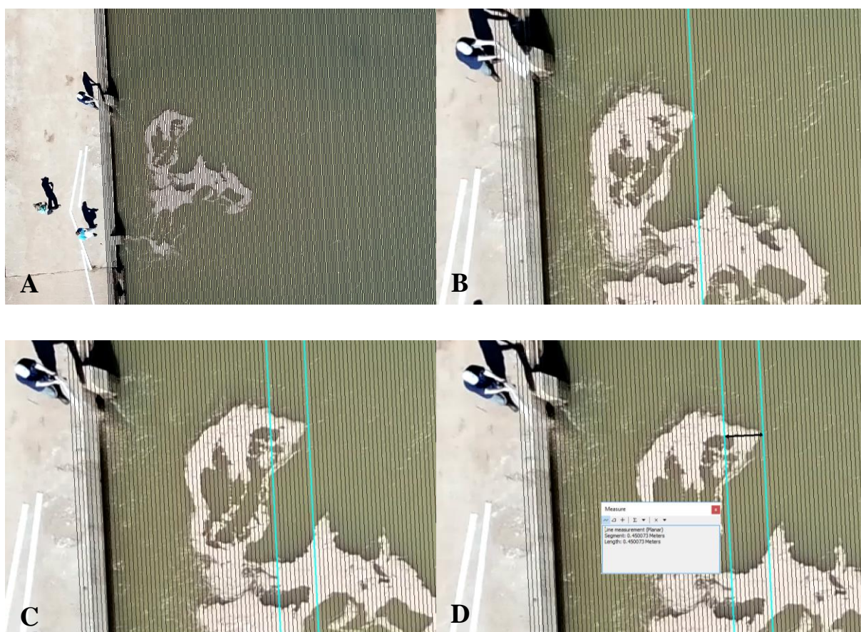
Figura 43: Procedimento de análise dos dados por meio de malha com utilização de serragem como traçador. Onde A: ilustração da malha sobreposta ao longo do trecho; B: Seleção da linha da malha demarcando o traçador na primeira imagem, junto a margem esquerda; C: Seleção da linha da malha demarcando o traçador na segunda imagem, junto a margem esquerda; e D: medição da distância entre as duas linhas consecutivas da malha na margem esquerda.
