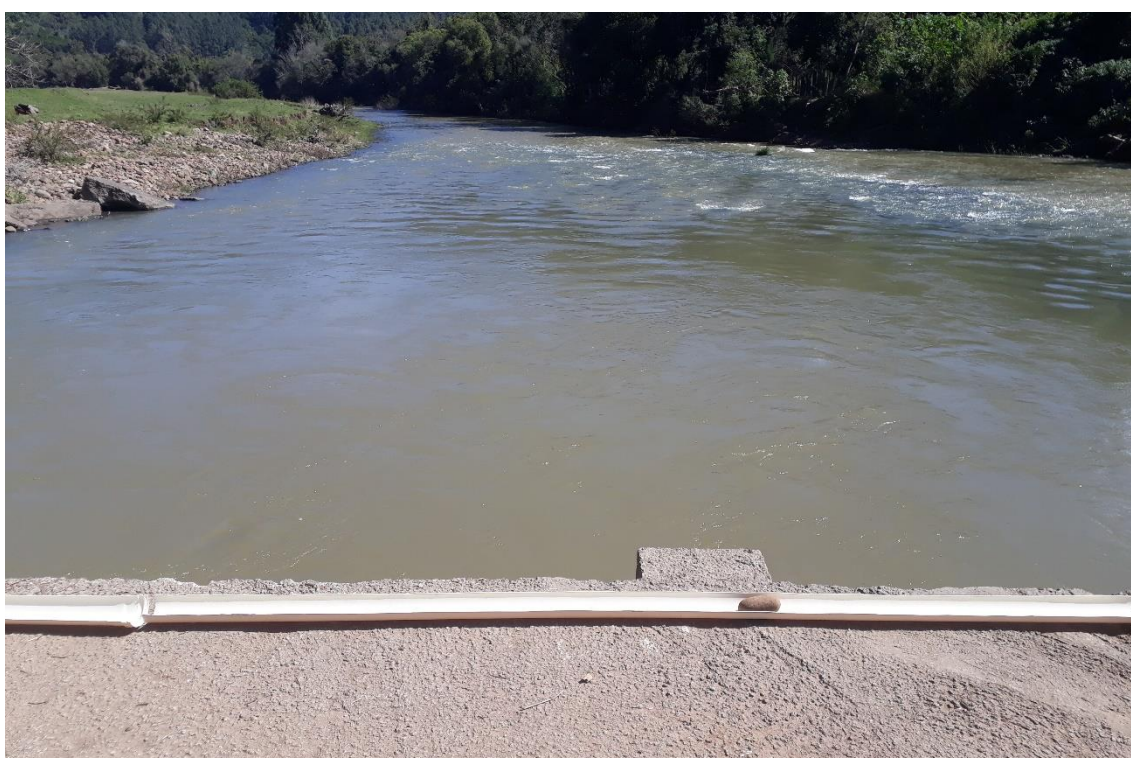
Figura 36: Posicionamento das meias seções de cano PVC para lançamento dos traçadores a jusante da ponte.
