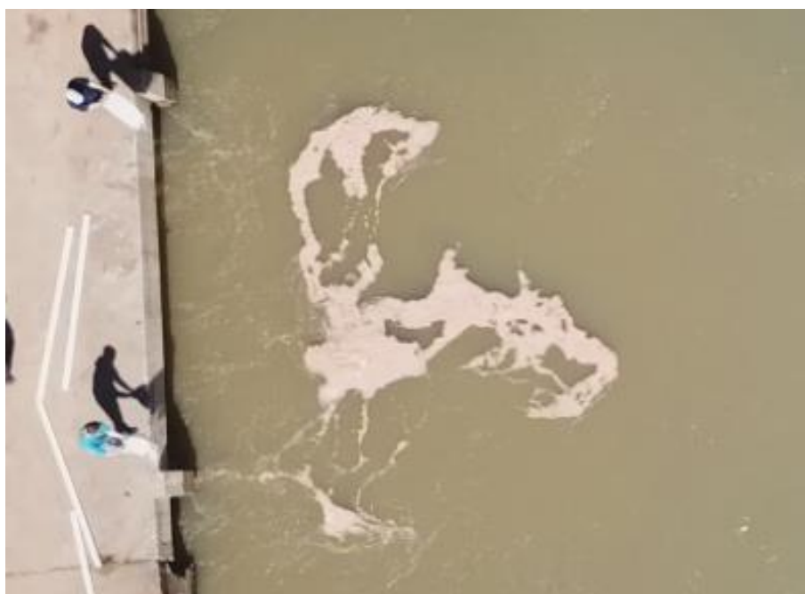
Figura 48. Resultados dos levantamentos utilizando serragem.
