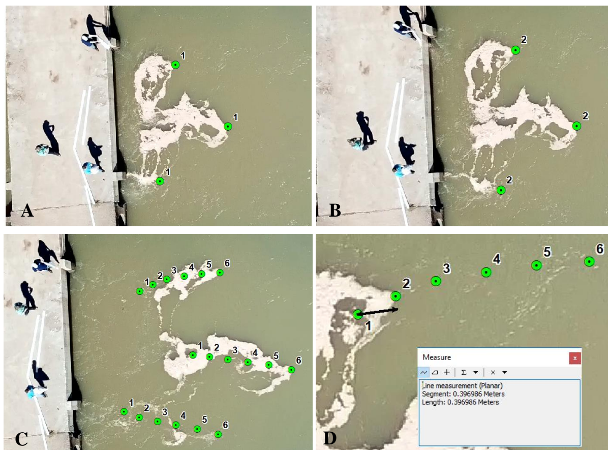
Figura 41: Procedimento de análise dos dados por meio de pontos com utilização de serragem como traçador. Onde A: delimitação dos pontos na primeira imagem; B: delimitação dos pontos na segunda imagem; C: delimitação dos pontos na sexta imagem e representação dos pontos demarcados; e D: medição da distância entre dois pontos consecutivos na margem esquerda.
