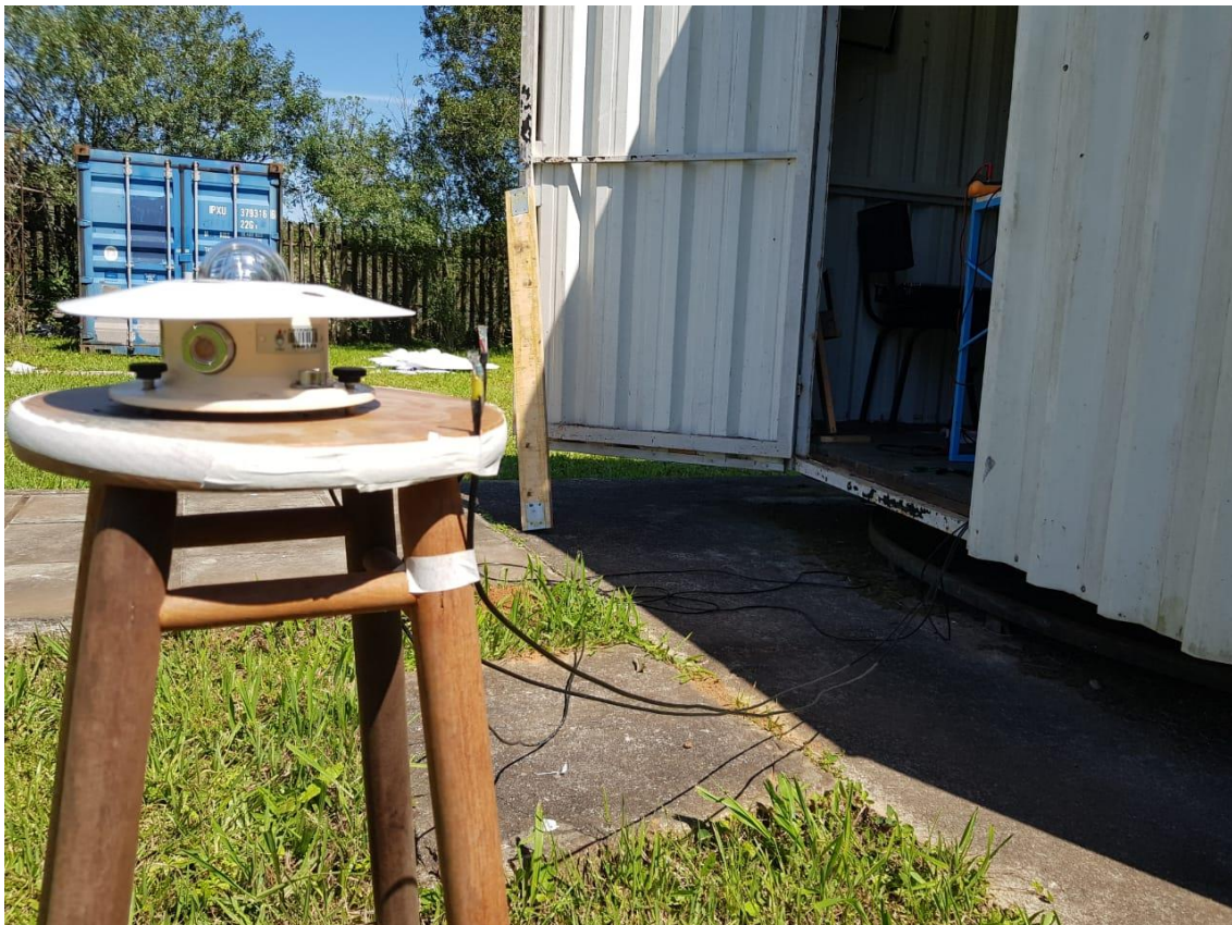
Figura 17. Piranômetro (centro) e sensores (borda) sendo calibrados
