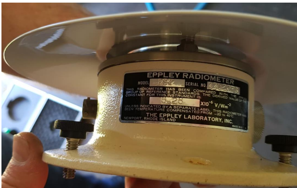
Figura 16. Vista do piranômetro e valor da constante de conversão.
