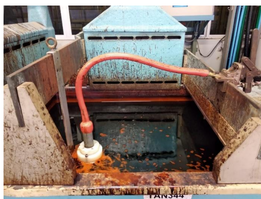
Figura 3.12 Processo de cromagem dos corpos de prova.
