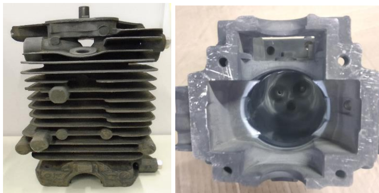
Figura 3.2 Corpos de prova utilizados na realização dos testes a partir de uma liga fundida A380.
