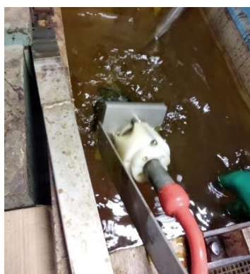
Figura 3.13 Lavagem dos corpos de prova para remoção do excesso de cromo.
