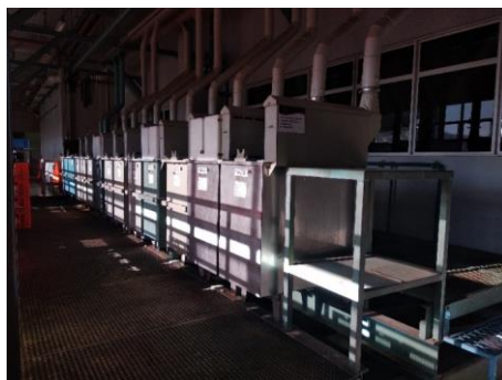
Figura 3.4 Linha de testes utilizada para a preparação dos corpos de prova e a cromagem.
