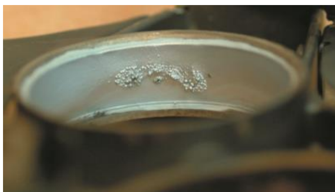
Figura 2.5 Depósito de cromo queimado.
