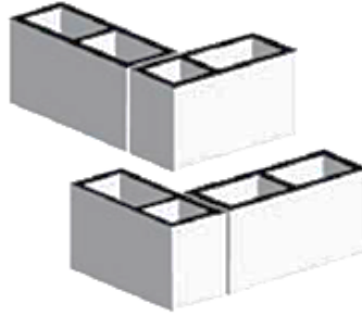
Figura 32 – Canto com módulo e largura diferentes, com bloco especial.
