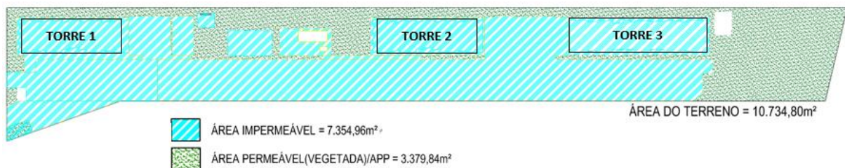
Figura 24 – Vista geral, áreas permeáveis e impermeáveis
