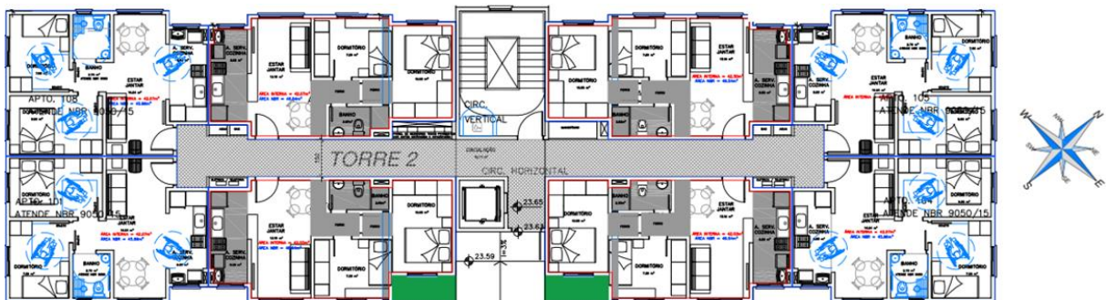
Figura 18 – Torre 2, sem cômodos de longa duração voltados para face Sul
