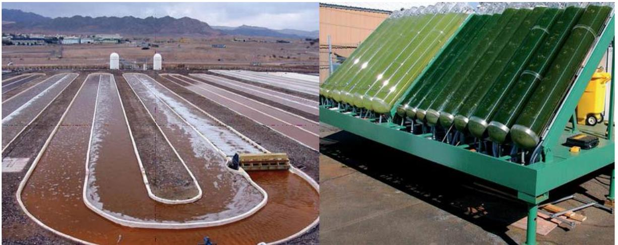
*Figura 1 – Produção de microalgas em lagoa de raceway (esquerda) e biorreatores (direita).*
