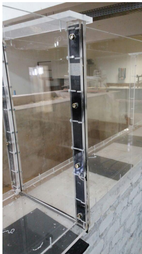
Figura 18 – Detalhe do acoplamento entre os módulos que formam o canal de acrílico.
