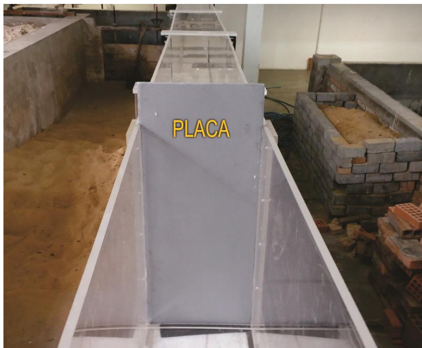
Figura 21 – Placa metálica que funciona como barramento do canal.
