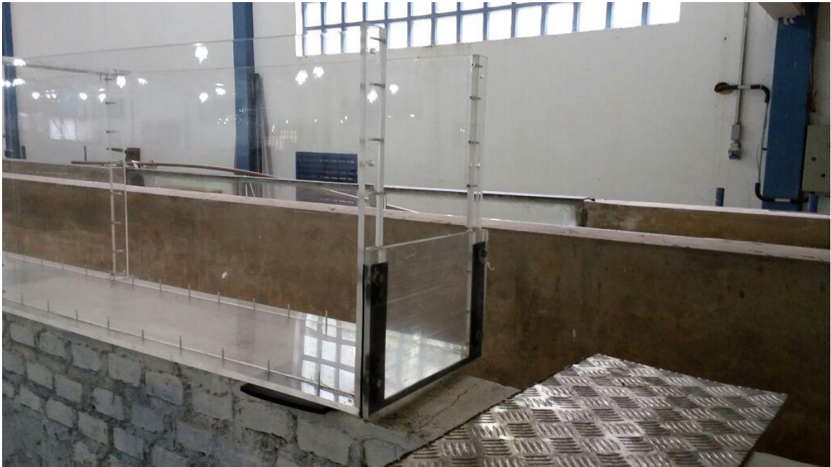
Figura 19 – Fim do canal de acrílico com placa de altura variada aparafusada e vedação em borracha.
