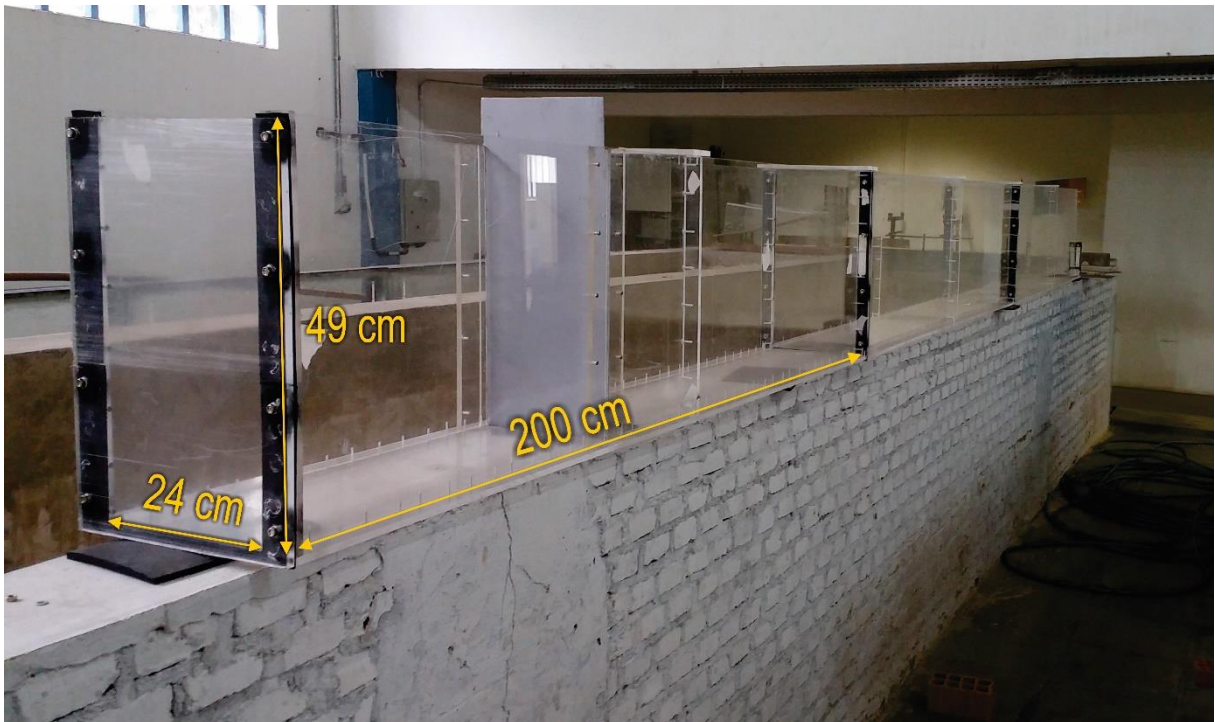
Figura 17 – Canal de acrílico, medidas referentes a um módulo de 2 metros.
