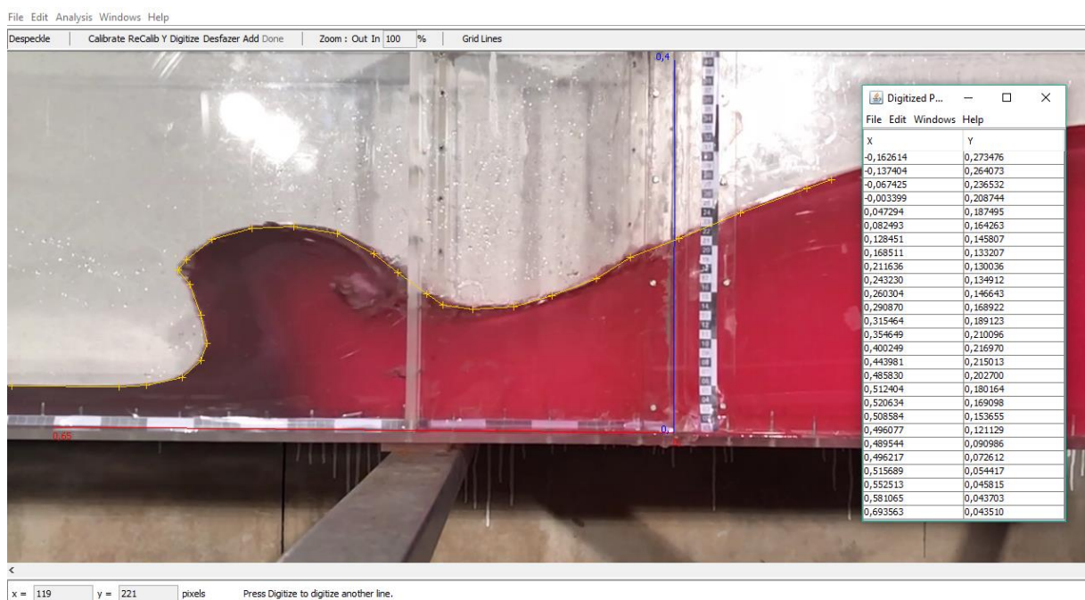
Figura 29 – Exemplo de identificação da linha d'água da onda de ruptura utilizando o aplicativo Plot Digitizer .
