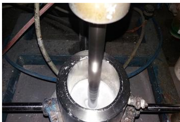
Figura 14: Preparo da tinta intumescente.
