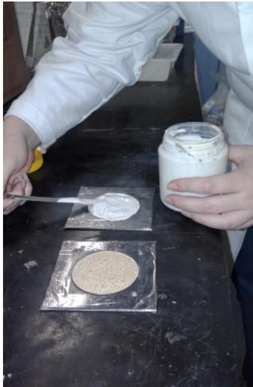
Figura 15: Aplicação da tinta nos corpos de prova.
