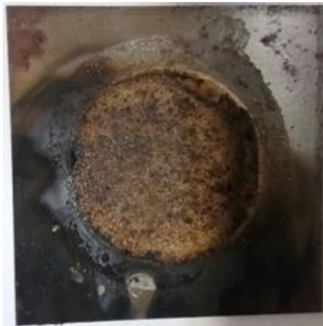
Figura 18: Coleta das cinzas dos revestimentos após teste de queima.
