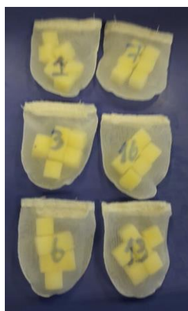
Figura 3.5 - Cubos de maçã para determinação da perda de massa
