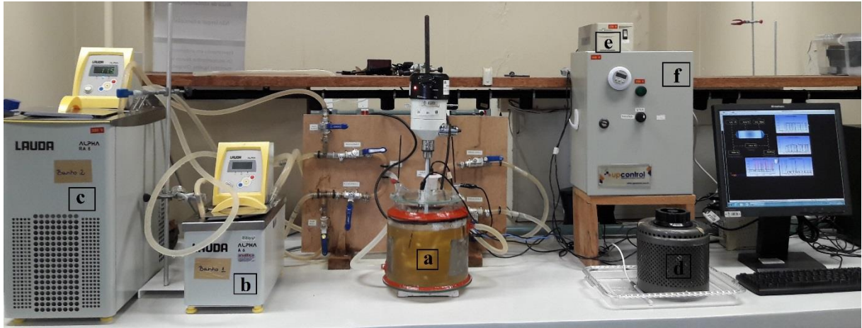
Figura 3.2 - Sistema experimental de desidratação osmótica assistida por MEF: (a) célula cilíndrica encamisada, (b) banho de aquecimento, (c) banho de resfriamento, (d) variador de tensão, e) estabilizador e f) sistema de aquisição de dados.
