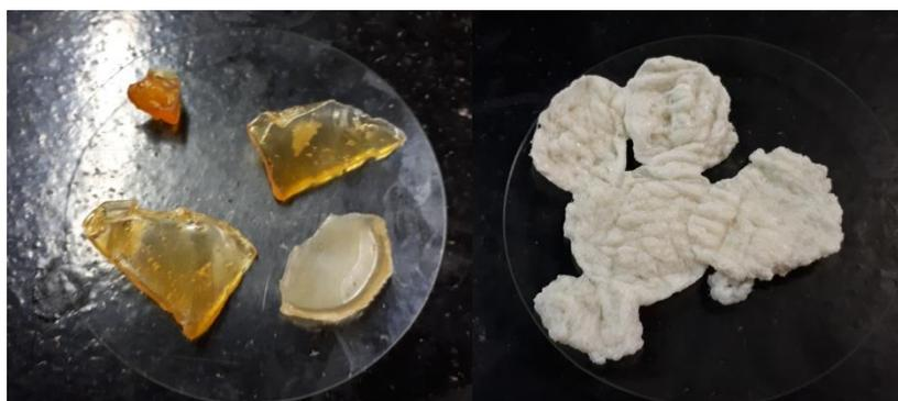
**Figura 8.** Comparação entre látex seco (esquerda) e PI epox (direita).
