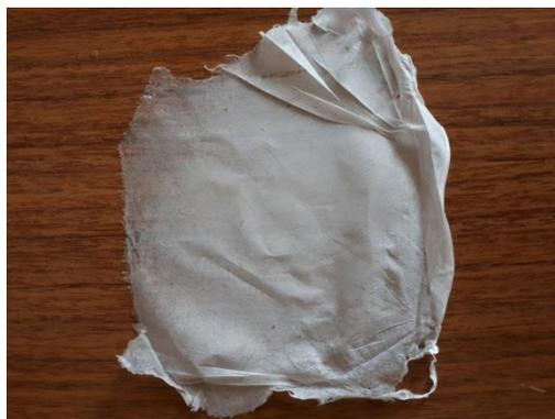
**Figura 10.** Membrana de Cellprene® epox obtida por *electrospinning*.
