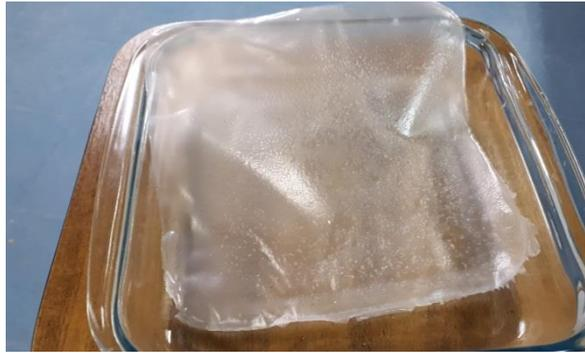
**Figura 9.** Membrana de Cellprene® epox após secagem em estufa.
