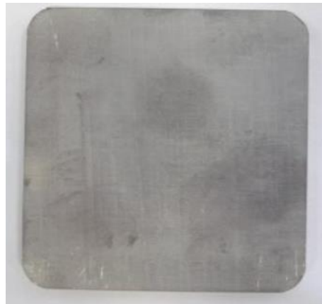
Figura 12 - Corpo de prova do aço DIN 1.4110 utilizado para análise de composição química.
