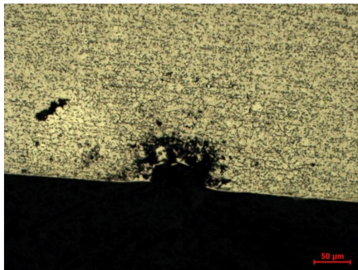
Figura 36 – Metalografia da seção transversal do aço inox DIN 1.4110 marcado a laser com espaçamento de 0,02 mm após ensaio de corrosão por imersão indicando a presença de corrosão intergranular.
