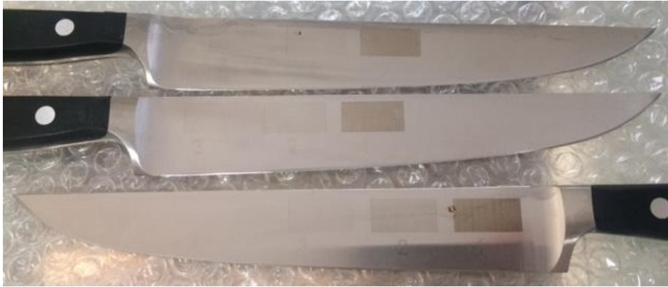
Figura 35 - Amostras montadas do aço inox DIN 1.4110 após ensaio de corrosão por névoa salina com marcação a seco.
