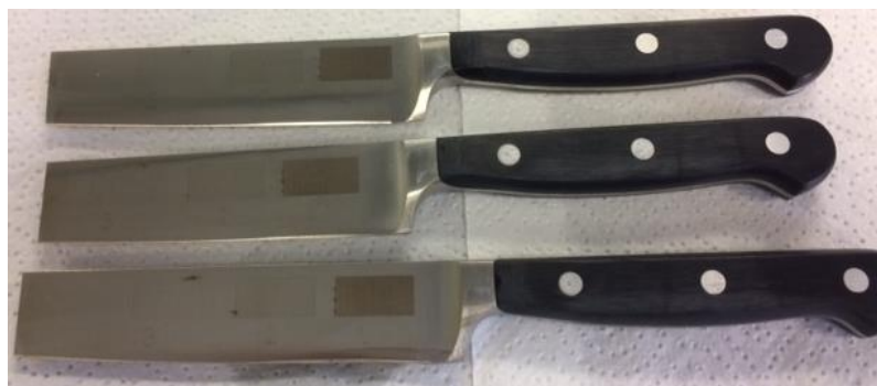
Figura 33 - Amostras em aço inox DIN 1.4110 após ensaio de corrosão por imersão com o produto montado – face B.
