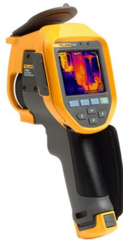
Figura 15 - Termovisor utilizado para medição da temperatura durante a marcação.
