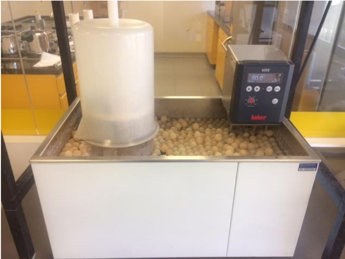
Figura 13 - Dispositivo para teste de imersão conforme a ISO 8442-2.
