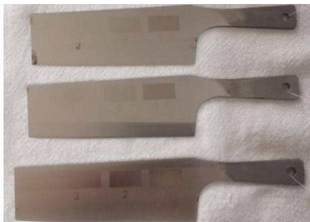
Figura 34 - Amostras sem montar de aço inox DIN 1.4110 após ensaio de corrosão por névoa salina com marcação a seco.
