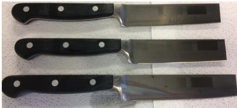
Figura 32 - Amostras em aço inox DIN 1.4110 após ensaio de corrosão por imersão com o produto montado – face A.
