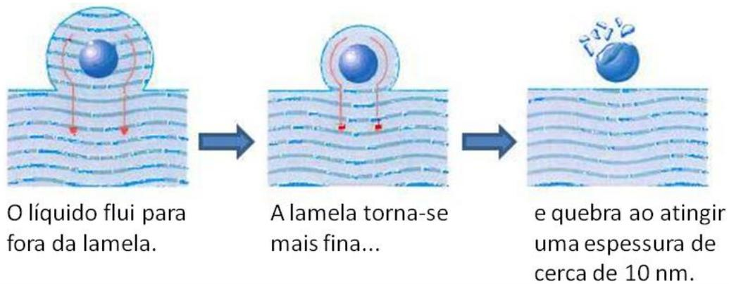
**Figura 6: Drenagem da lamela levando a quebra da bolha [23].**
