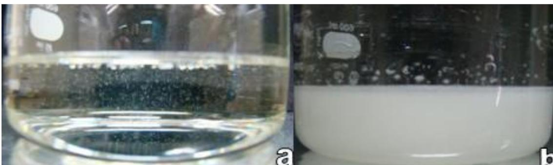
Figura 14: Resina epóxi (a) antes e (b) depois da agitação.
