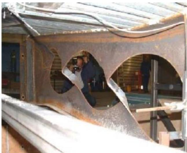
**Fig. 15** Falha por flambagem do montante da alma por cisalhamento. (Bake, 2010)
