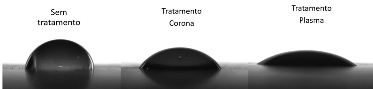
Figura 47 - Imagem da gota formada na superfície de uma placa de PP sem tratamento, com tratamento corona e tratamento plasma ao vácuo, da esquerda para a direita.
