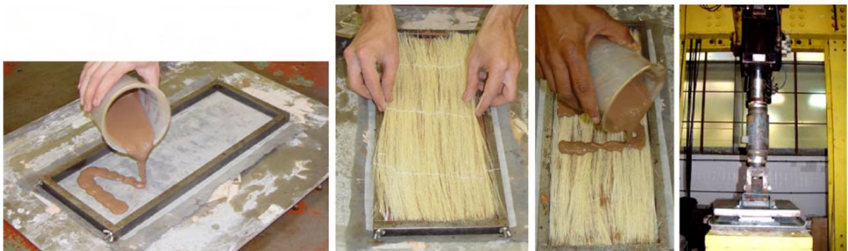
Figura 15 - Processo de produção de compósitos cimentícios com fibras longas de sisal (42).
