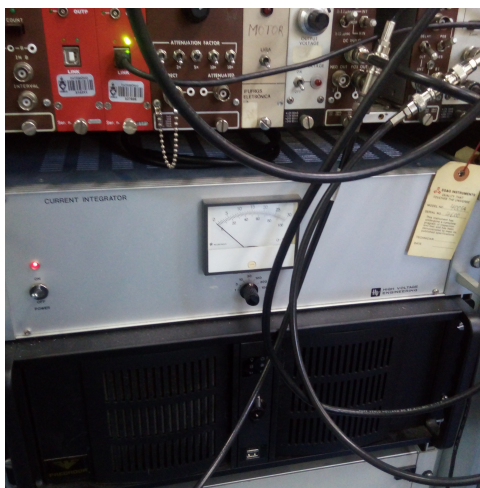
Figura 12 – Módulo Integrador presente no laboratório de implantação iônica.
