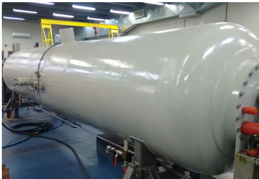
Figura 6 – Acelerador do tipo Tandatron 3MV - High Voltage Engineering Europa BV presente no LII-UFRGS.
