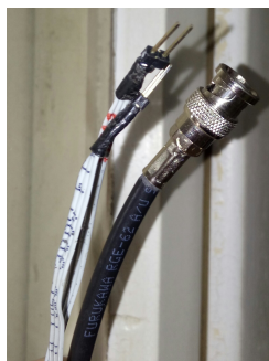
(b) Cabo coaxial com uma de suas pontas adaptadas para o tipo de entrada suportado pelo microcontrolador.
