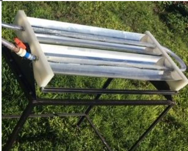
Figura 1 - Reator CPC utilizando catalisador imobilizado.
