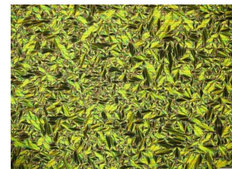
Figura 1. Textura 2b obtida em 194°C com amostra alinhada (10°C/min). Mesofase SmA.
