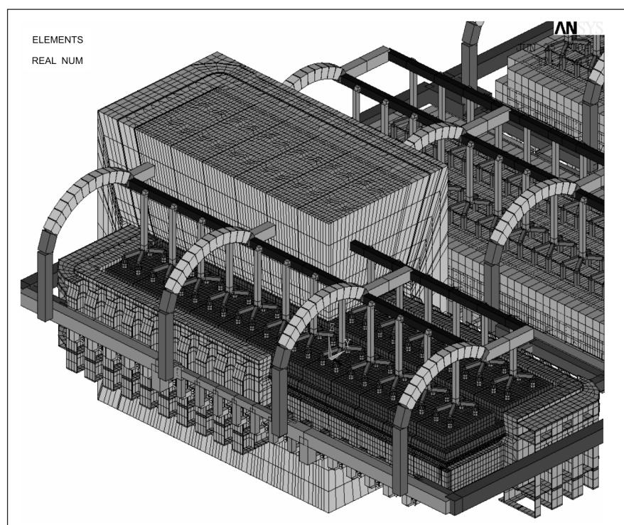
Figura 1 - Modelo matemático de uma cuba *side-by-side* com *side risers* de ânodos pré-cozidos.
