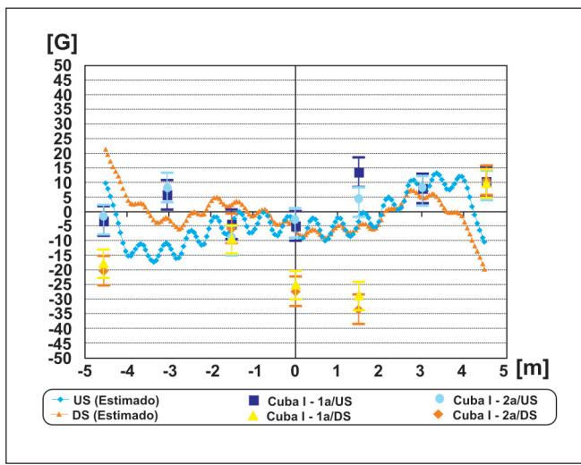
Figura 6 - Comparação entre  $B_y$  medido e calculado para a Cuba I.
