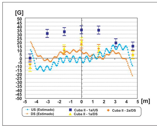
Figura 9 - Comparação entre  $B_y$  medido e calculado para a Cuba II.
