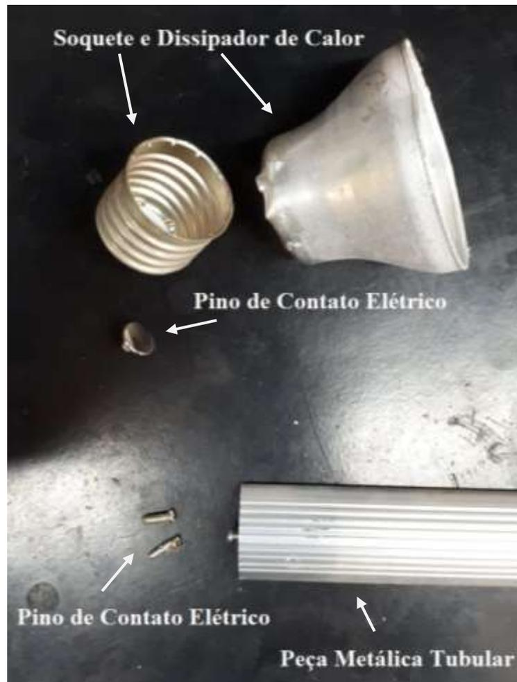
Figura 16 – Peças metálicas da carcaça
