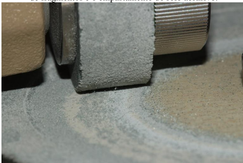
Figura 11: Corpo de prova de Laminado, apresentando em destaque o grande acúmulo de depósito de fragmentos e o empastamento do rolo abrasivo.
