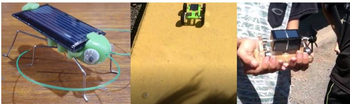
Grilo e carro com células fotovoltaicas e Experimento de Levitação Magnética com motor solar para giro.<sup>47</sup>
