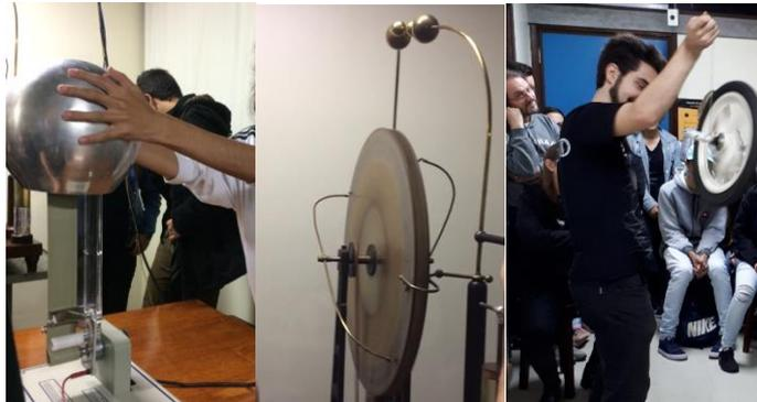
Alguns outros experimentos diversificados realizados, com gerador de Van der Graaff<sup>53</sup>, máquina de Wimshurst<sup>54</sup> e efeito giroscópico<sup>55</sup>.
