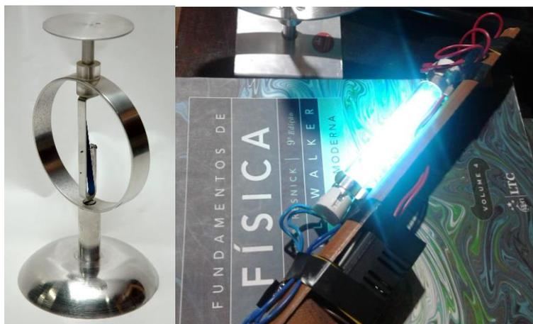
Eletroscópio<sup>42</sup> e lâmpada para emissão de raios UV<sup>43</sup>.
