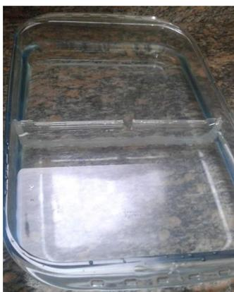
Equipamento utilizado para ilustrar a difração com ondas de água.<sup>49</sup>
