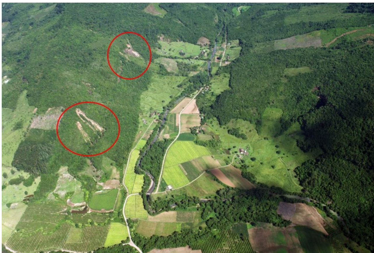
Figura 2 – Ocorrência de escorregamentos em encosta na bacia do rio Maquiné. Fonte: ANAMA.
