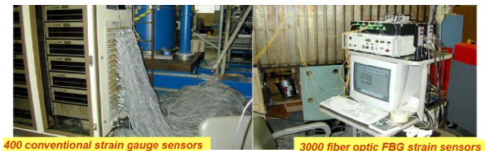
Figura 4 – Cabeamento para ERE (esquerda) e para FBGS (direita).
