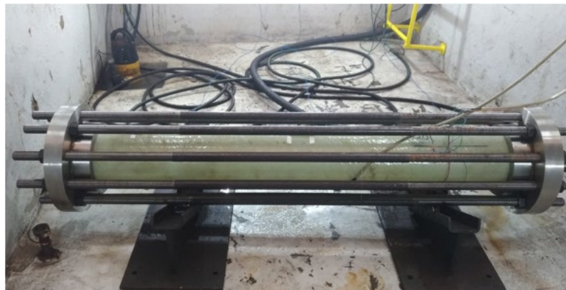
Figura 39 – Amostra de tubo compósito de PRFV posicionada no bunker para ensaio de explosão.
