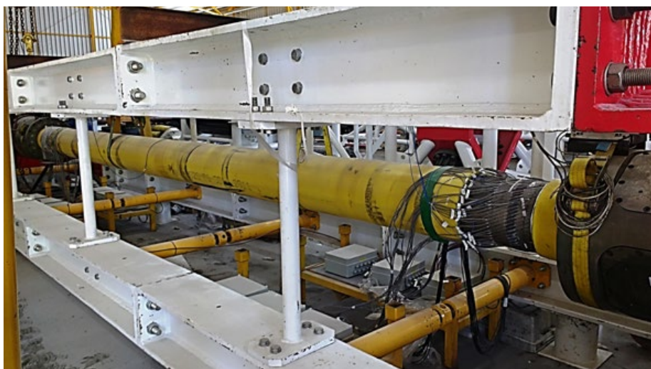
Figura 27 – Segmento de duto flexível posicionado na bancada de ensaio.
