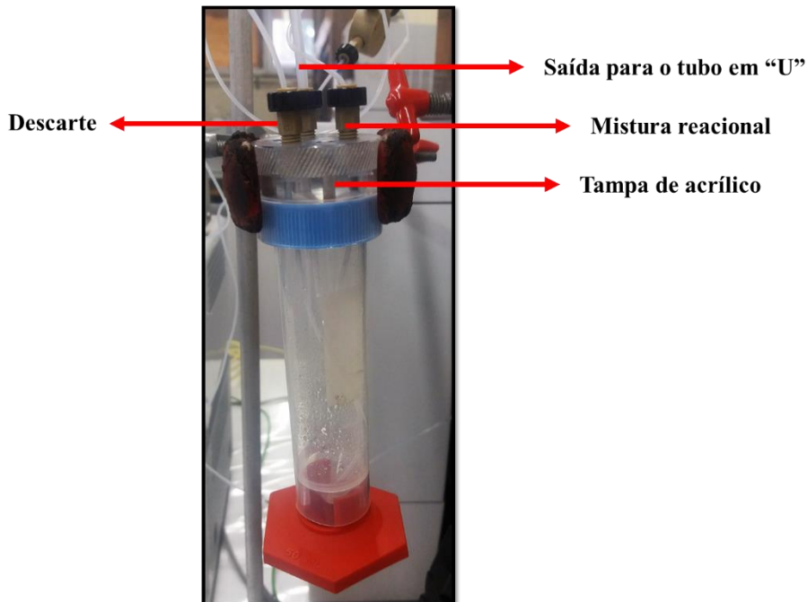
Figura 7. Frasco de polietileno modificado para uso como separador gás-líquido na análise de especiação química de As mediante HG-CT-AAS.
