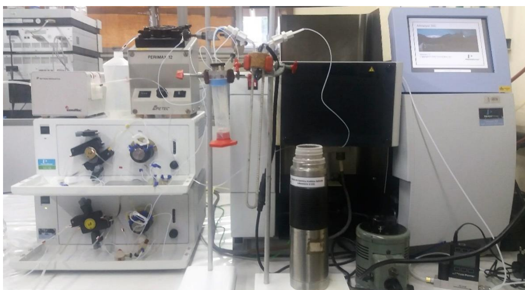
Figura 9. Montagem do sistema utilizado para análise de especiação química de As por HG-CT-AAS
