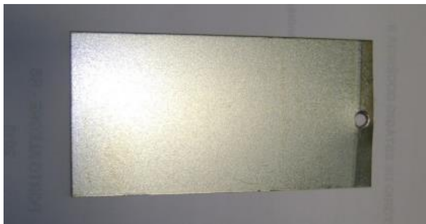
Figura 13 - Amostra eletrozincada ativada com ácido nítrico 5mLapós a eletrodeposição As etapas seguintes para obtenção da dupla camada de revestimento com tanino e solução de conversão à base de Zr (“nanocerâmico”) foram realizadas conforme descrito anteriormente para as amostras de aço galvanizado.
