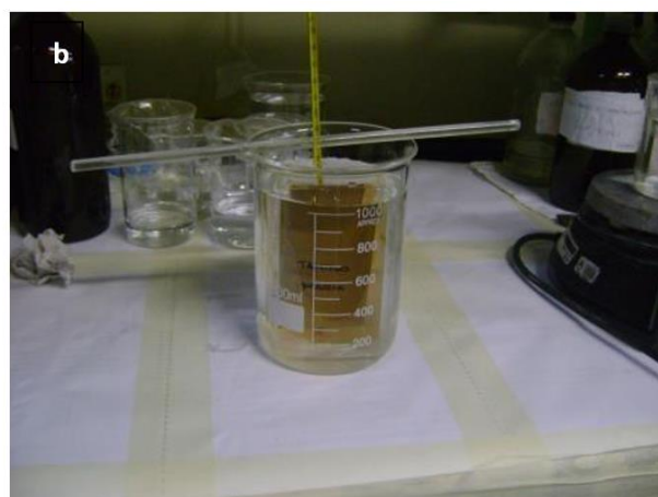
Figura 12–a) Esquema de aplicação do revestimento de tanino; b) Amostra imersa em solução de tanino na célula de acrílico, para formação do revestimento, conforme esquema representado em a)
