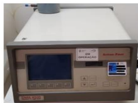
Figura 12 - Densímetro utilizado para leitura das massas específicas de gasolina e óleo diesel. Fonte: CECOM.
