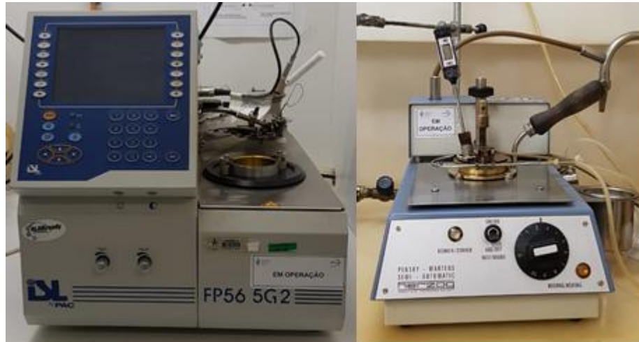
Figura 14 - Medidores de ponto de fulgor de diesel. A esquerda, o medidor automático (TAG) e a direita, o medidor manual (Pensky-Martens). Fonte: CECOM.
