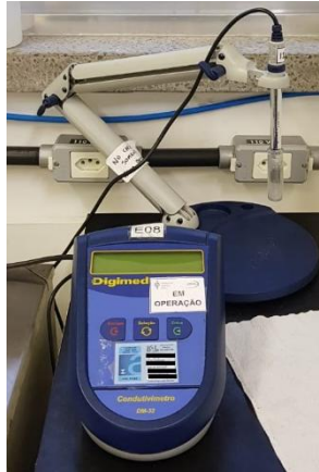
Figura 16 - Condutivímetro utilizado para medidas de condutividade em etanol combustível. Fonte: CECOM.
