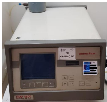
Figura 12 - Densímetro utilizado para leitura das massas específicas de gasolina e óleo diesel. Fonte: CECOM.
