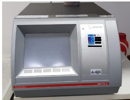
Figura 15 - Densímetro para leitura de massa específica e teor alcoólico em etanol combustível. Fonte: CECOM.
