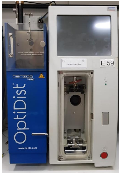
Figura 13 - Destilador para leituras dos pontos de ebulição dos componentes contidos em óleo diesel e gasolina. Fonte: CECOM.
