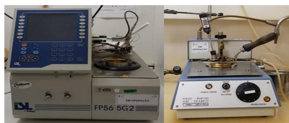
Figura 14 - Medidores de ponto de fulgor de diesel. A esquerda, o medidor automático (TAG) e a direita, o medidor manual (Pensky-Martens). Fonte: CECOM.
