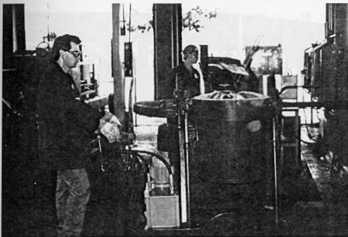
Fig.13 - Cadinho de transporte em operação no abastecimento dos fornos de espera do setor de injetoras.
