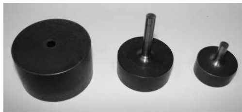
Figura 3.1 Matriz para compactação da amostra tipo cilindro.
