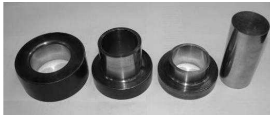
Figura 3.1 Matriz para compactação da amostra tipo cilindro.
