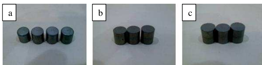
Figura 3.4 Amostras para ensaio de compressão: a) amostra original b) compósito com 3% resina HRJ10236 ® c) compósito com 3% resina CR2001 ® .
