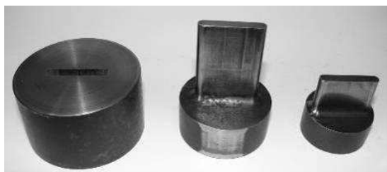
Figura 3.3 Matriz para compactação da amostra tipo barra.
