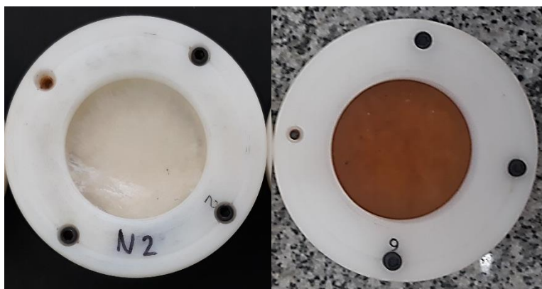
Figura 20 – Cápsulas utilizadas para o ensaio de permeabilidade ao vapor d'água. Esquerda: blenda TPS/PP. Direita: blenda TPS/PSC/PP
