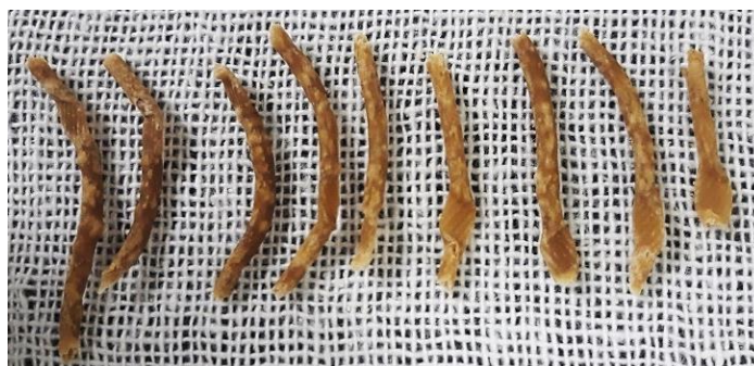
Figura 60 - Imagens-das amostras TPS/PSC/PP/C14 (70/20/10/3) após o ensaio de IF
