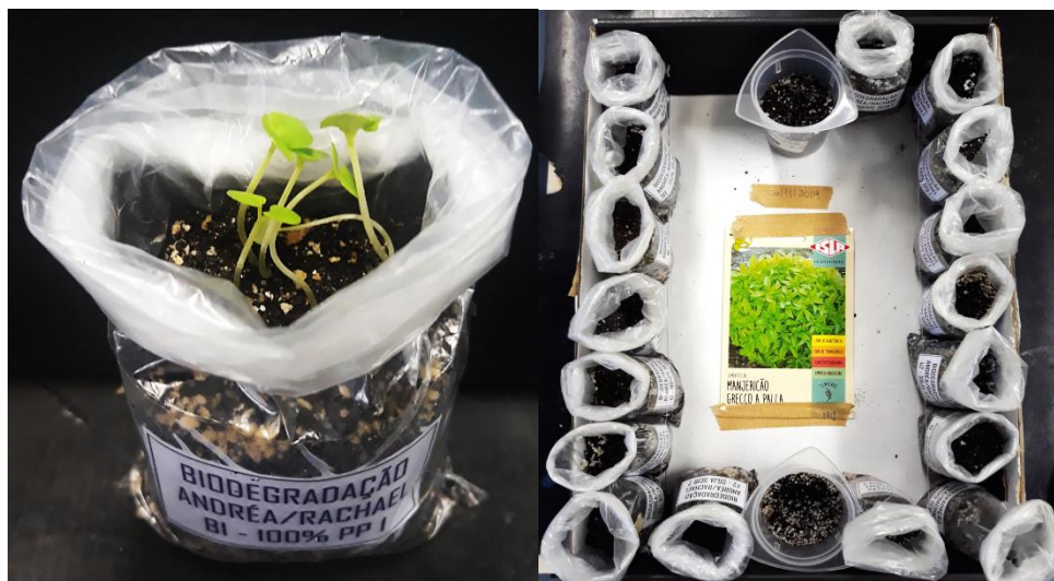
Figura 22 – Ensaio de eco-toxicidade e germinação. Esquerda: sementes germinadas após 3 semanas. Direita: suporte utilizado durante o ensaio
