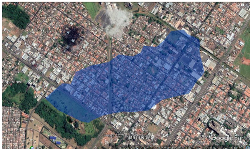
Figura 5: Área de Contribuição obtida através dos MDE's com resolução de 30 metros exibida em imagem aérea.
