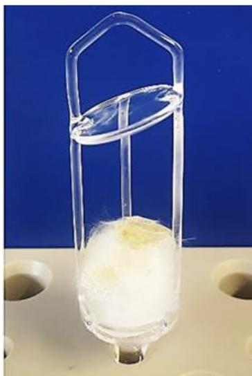
**Figura 15.** Suporte de quartzo contendo 200 mg de biodiesel e 150 mg de lã de vidro antes do procedimento de MIC.
