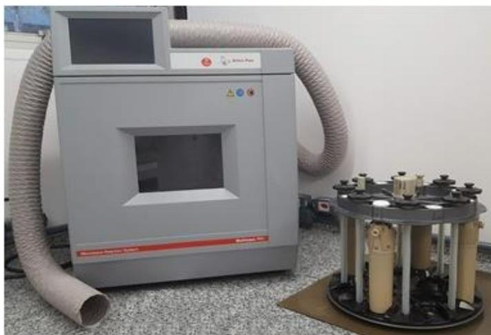
**Figura 5.** Forno de micro-ondas e rotor com os frascos utilizados nos procedimentos de decomposição por combustão iniciada por micro-ondas.
