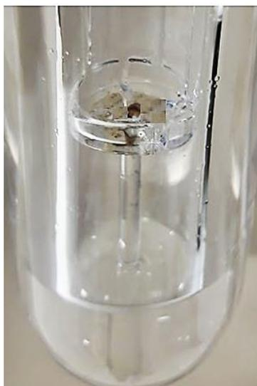
**Figura 11.** Registro de imagem do frasco e do suporte de quartzo após decomposição de 750 mg de arroz por MIC utilizando água como solução absorvedora.
