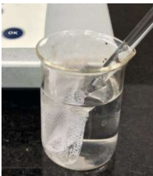
Figura 15 - Solução salina com amostra de nãotecido na análise de tensão superficial
