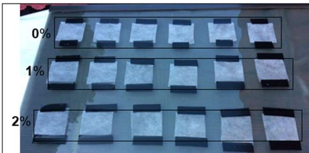
Figura 18 - Sistema de exposição das amostras ao intemperismo natural
