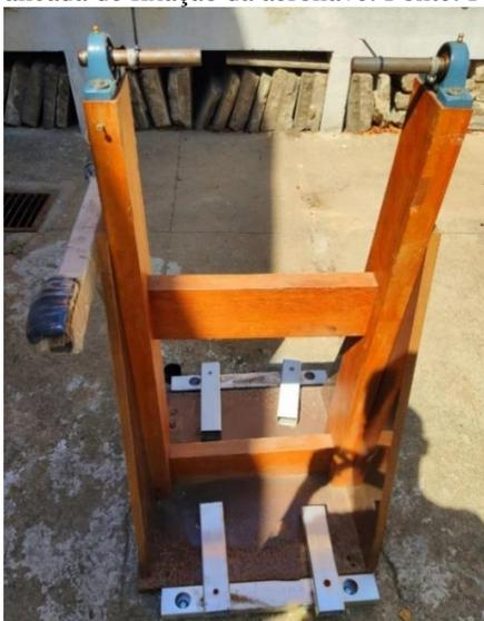
Constituída basicamente por madeira e com dimensões de 580 x 580 mm de base e 1120 mm de altura, a bancada é presa ao solo. Na parte superior estão situados mancais que anexam eixos com finalidade de fixar a aeronave.
