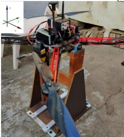
Fixado na bancada, o drone tem seu movimento de translação limitado nos eixos x, y e z, estando livre para girar no eixo x. O teste necessita que o equipamento permaneça em equilíbrio para evitar leituras que não sejam de vibração da estrutura no acelerômetro.
