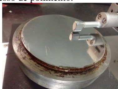
Figura 4.6 - Medição de rugosidade na orientação transversal em um disco após o processo de polimento.
