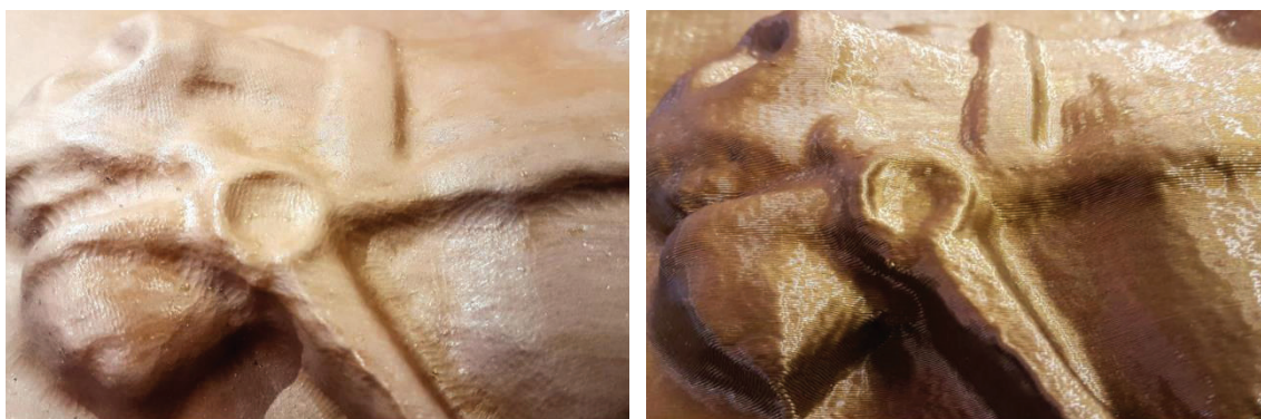
Figura 7: Detalhes das superfícies das peças fabricadas. A) Peça produzida por usinagem CNC; B) Peça produzida por impressão 3D por FFF.
