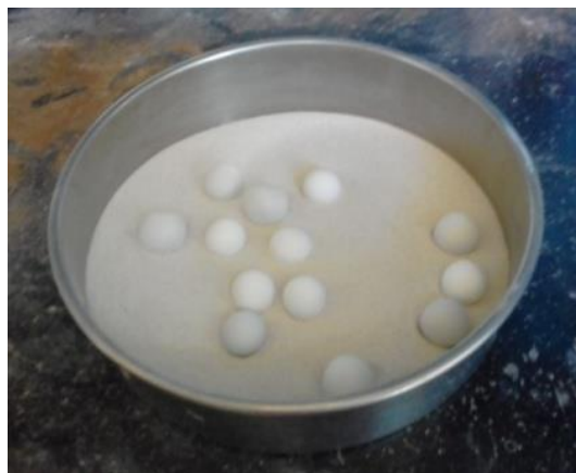
Figura 4.9 - Isolador moído após moinho de bolas. Fonte: O autor (2019).
