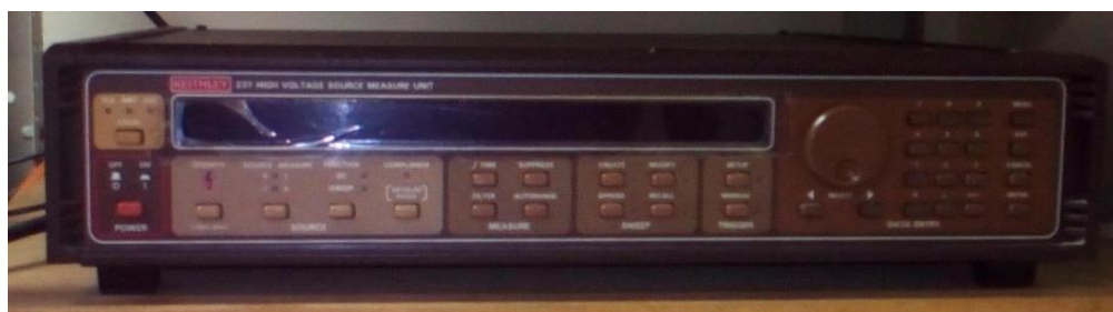
Figura 4.16: Fonte de alta tensão (LABIOMAT-UFRGS). Fonte: O autor (2019).
