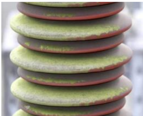
Figura 3.2 - Contaminação Biológica em Isolador Polimérico. Fonte: (YANG et al. , 2017).
