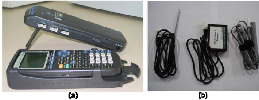
Figura 1 - Sistema CBL. Em (a) temos a calculadora gráfica e o dispositivo de coleta automática de dados, e em (b) alguns sensores como o de temperatura, o de pressão em gases e o de intensidade luminosa (mostrados da esquerda para a direita).
