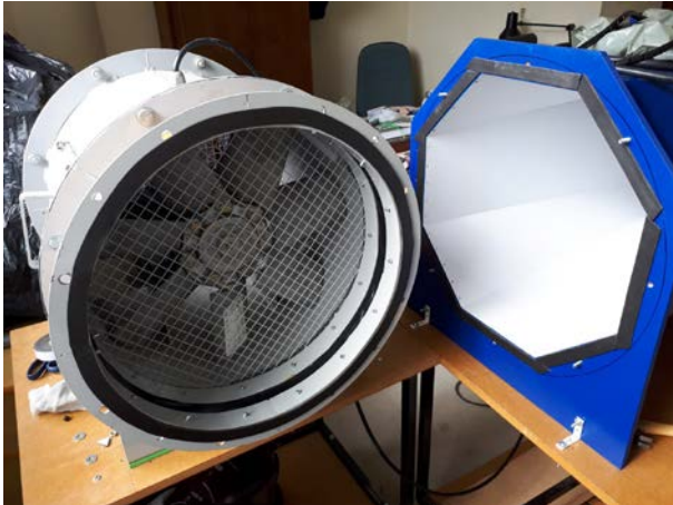
Figura 20 Junta flexível e divergente.
