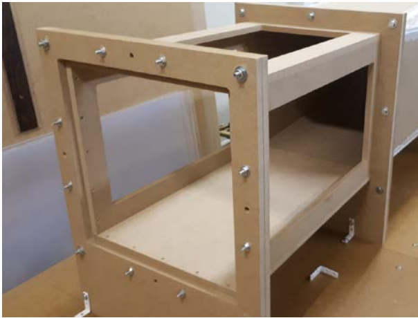
Figura 14 Seção de testes com três janelas de inspeção e furação para conexões entre as partes adjacentes.
