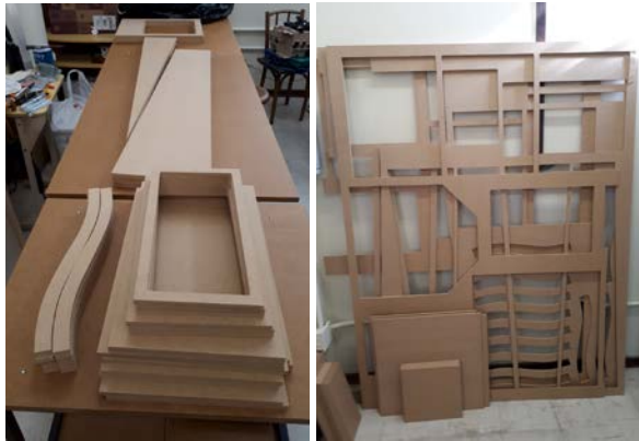
Figura 5 Peças cortadas por fresadora CNC.
