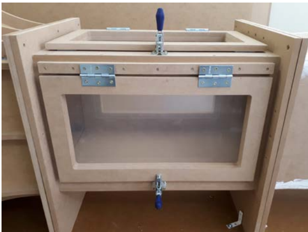
Figura 15 Seção de testes com três janelas e ferragens de articulação e de fechamento.
