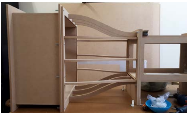
Figura 10 Posicionamento das longarinas do convergente.
