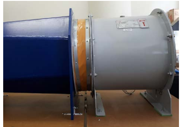
Figura 21 Junta flexível e separação entre as mesas do TV.
