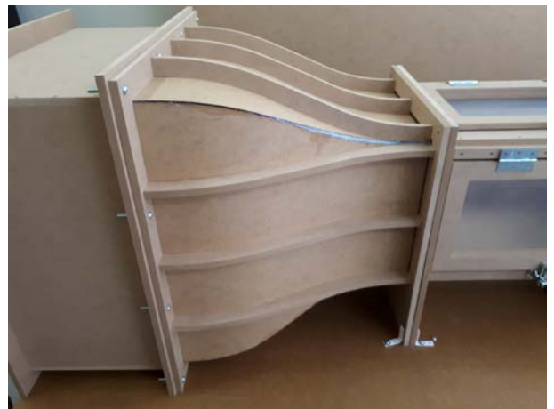
Figura 12 Montagem do convergente do TV.
