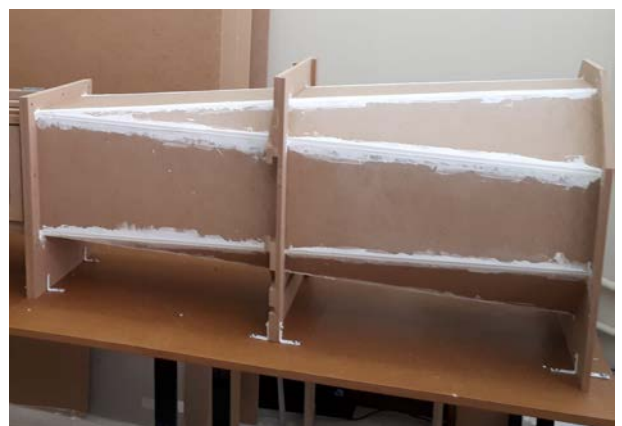
Figura 18 Aplicação de massa corrida nas junções das faces do divergente.
