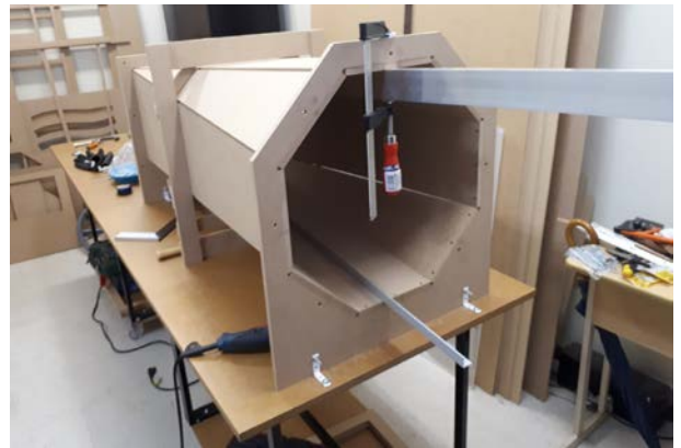
Figura 17 Montagem do divergente do TV.
