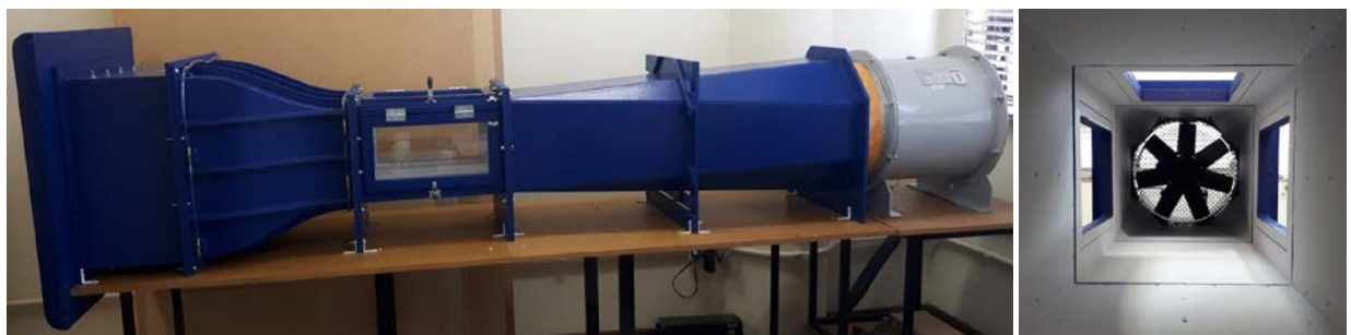
Figura 23 Vista lateral exterior do túnel de vento em sua versão finalizada e vista interna a partir do convergente - TV do LEA.
