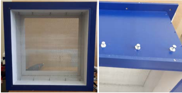
Figura 8 Telas metálicas e dispositivo de ajuste de tensão da tela de barlavento.
