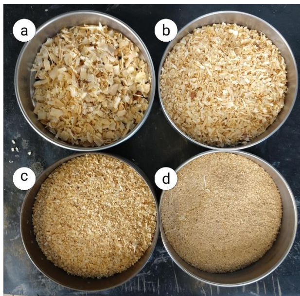
Figura 16 – Segregação da serragem de pinus por diferentes tamanhos de partículas: (a) serragem não passante em peneira com malha de 8 mm, (b) serragem passante em malha de 8 mm e retida em malha de 4,75 mm (c) serragem passante em malha de 4,75 mm e retida em malha de 1,75 mm (d) serragem passante em malha de 1,75 mm.
