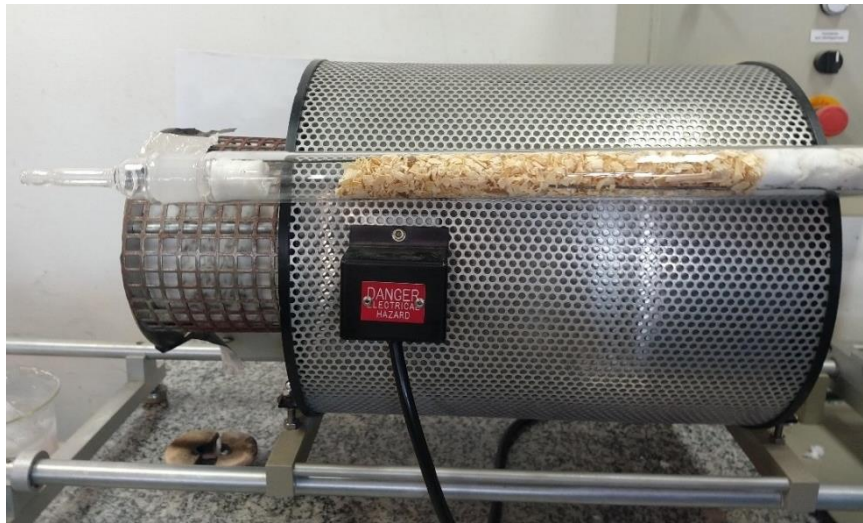
Figura 13 - Reator em quartzo utilizado nas experiências de pirólise térmica e catalítica
