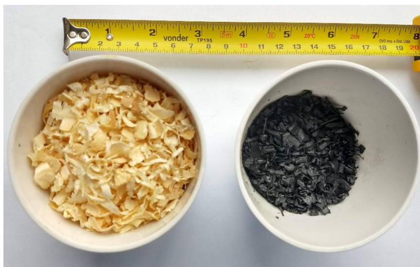
Figura 19 – Preparação para quantificação gravimétrica: Serragem de pinus e biochar produzido a partir da serragem de pinus a 30 °C/min, temperatura de pirólise de 550 °C e 30 min de tempo de patamar.
