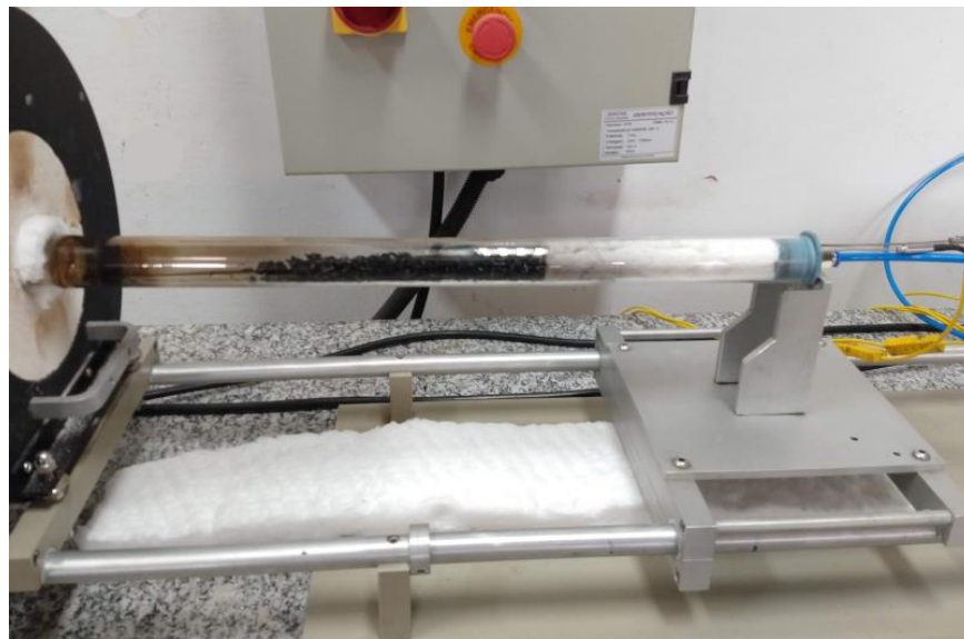
Figura 18 – Reator de quartzo arrefecendo após experimento de pirólise, sendo mantido o fluxo de N 2 para o biochar não entrar em ignição no caso de haver entrada de ar no reator de quartzo, e prevenir também a absorção de umidade do ar.
