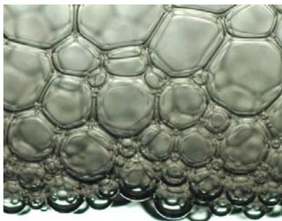
Figura 1.7 – Imagem de espuma drenada, com os diversos regimes de [11]. Imagem de um tubo contendo espuma inicialmente molhada que, pela ação gravitacional, teve a água drenada para o fundo, fazendo com que a parte superior da espuma esteja no limite seco com bolhas poliédricas e gradualmente mais molhado até o fundo, onde  $\phi \rightarrow 1$ , com bolhas esféricas.
