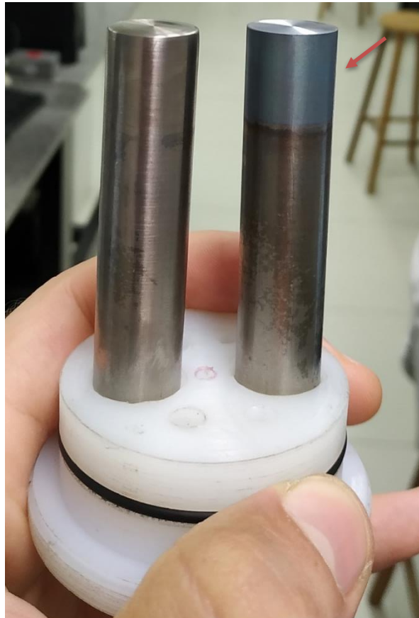
Fig. 4.9. Camada oxidada formada nos eletrodos de titânio após a reação de eletrólise.
