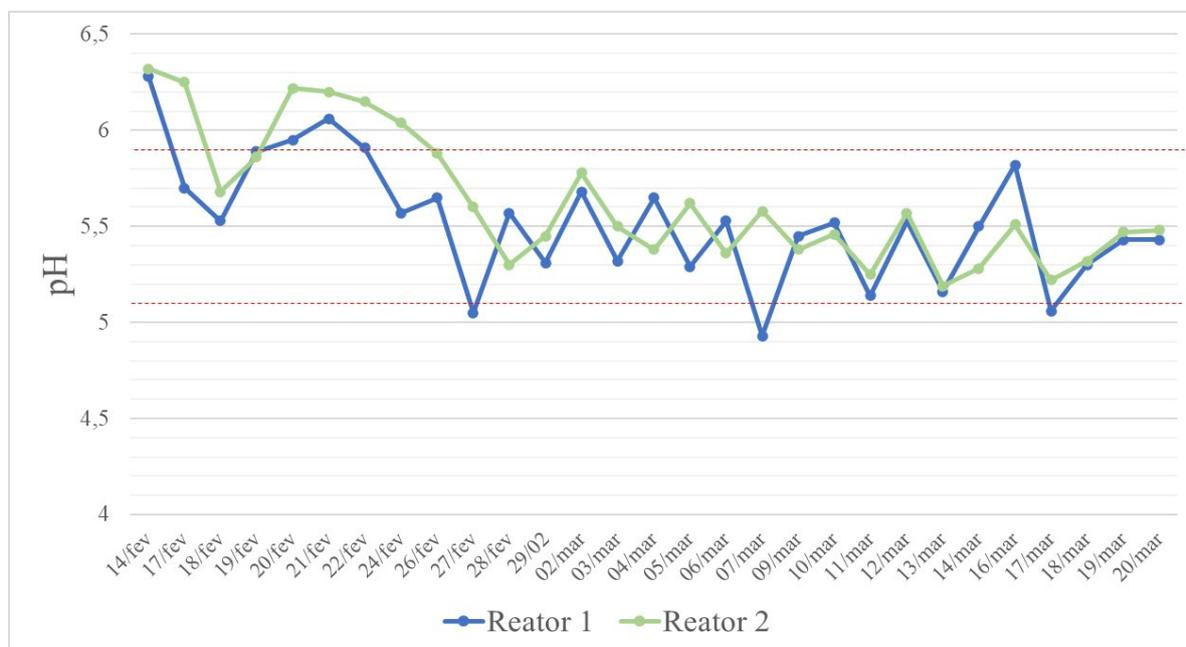
**Figura 3: Oscilação do pH dos biorreatores registrada durante o experimento. As linhas vermelhas tracejadas indicam a faixa de pH mais favorável aos bioprocessos alvo.**
