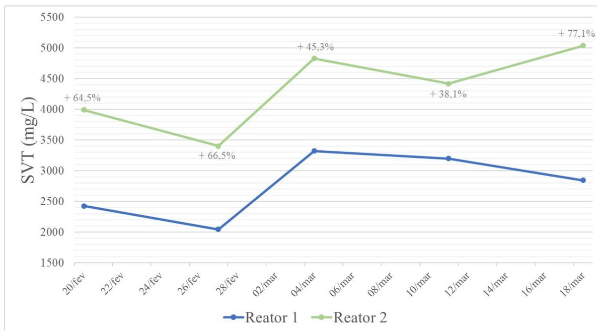
**Figura 5: Concentração de SVT nos biorreatores durante o experimento. Os valores percentuais indicam a diferença entre o Reator 2 e o Reator 1.**
