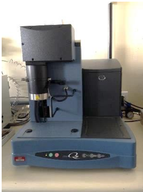
Figura 30. Equipamento de análise termogravimétrica, modelo TGA Q50 TA Instruments.
