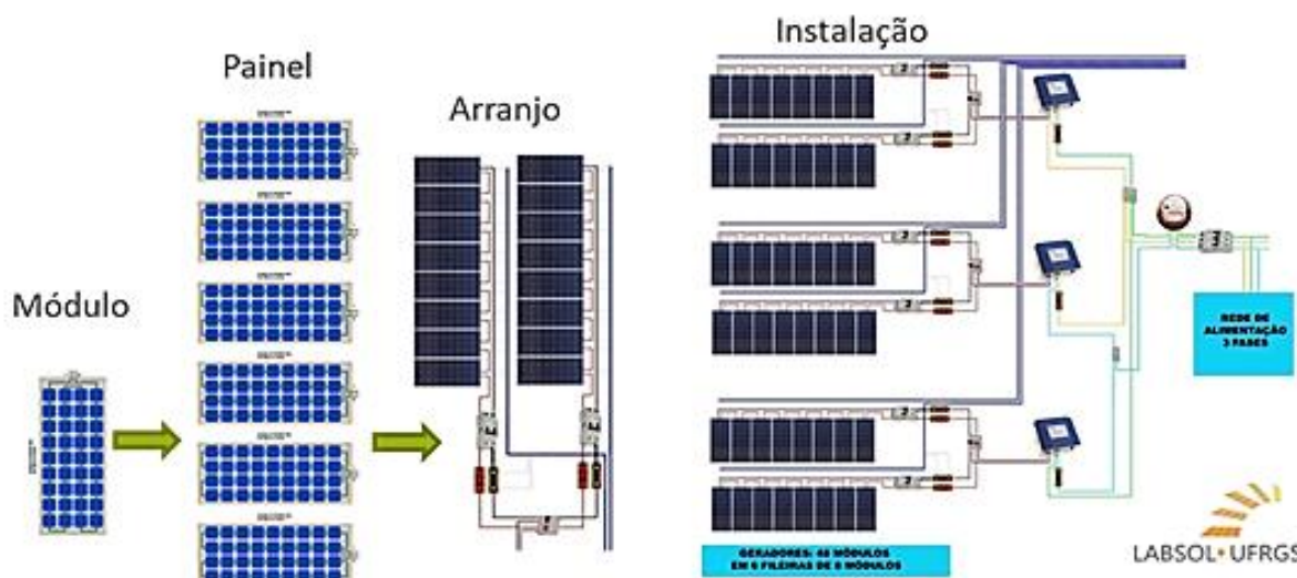
Figura 2. Módulo, painel, arranjo e instalação fotovoltaica. Fonte: Adaptado de Krenzinger (2019).
