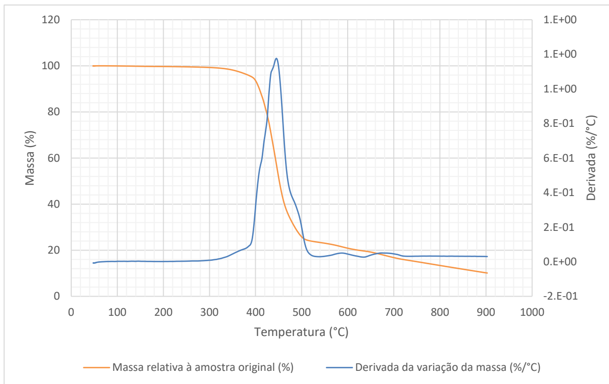
Figura 36. TG/DTG do backsheet sob atmosfera inerte. Fonte: a autora (2021).
