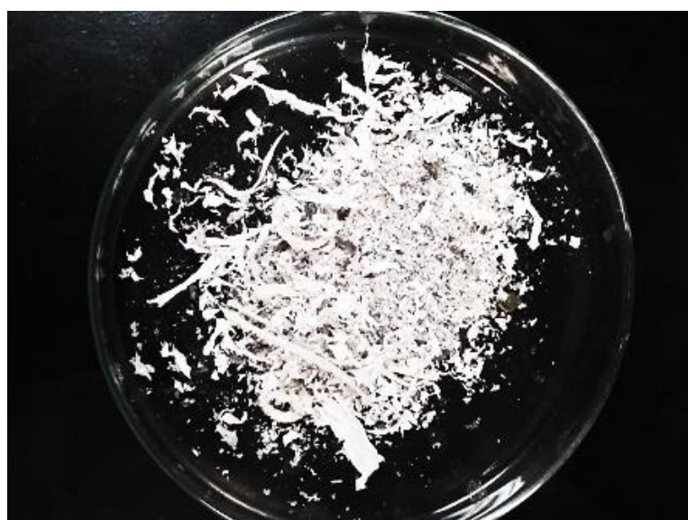
Figura 49. Lascas de backsheet delaminado por pré-tratamento mecânico com fresa, executado na Rota 2. Fonte: a autora (2021).
