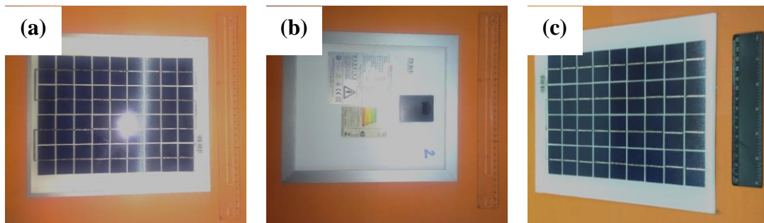
Figura 26. Módulo fotovoltaico utilizado no estudo (a) vista frontal (b) vista traseira (c) módulo sem moldura de alumínio e sem caixa de junção. Fonte: autora (2021).
