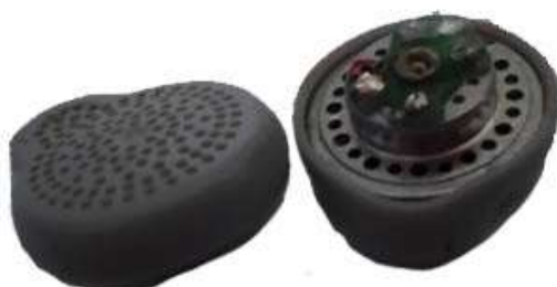
Figura 31- Tampa frontal contendo a estrutura metálica e ímãs para processamento
