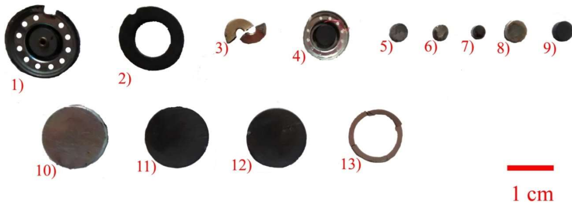
Figura 10 - Diferentes tipos de ímãs de fones de ouvido após a etapa de desmontagem manual, ilustrando diferentes geometrias de ímãs, tamanhos, cores de revestimento dos ímãs, como também variações de projeto (ímãs colados ou rebitados) na estrutura metálica do fone de ouvido
