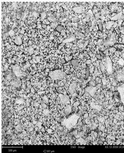
Figura 21 - Imagens por MEV e espectros de EDS para área total da imagem; amostras de fones cominuídos a 325 mesh com aumento de 380x, tensão de aceleração de 15 keV (Fonte: Autor)
