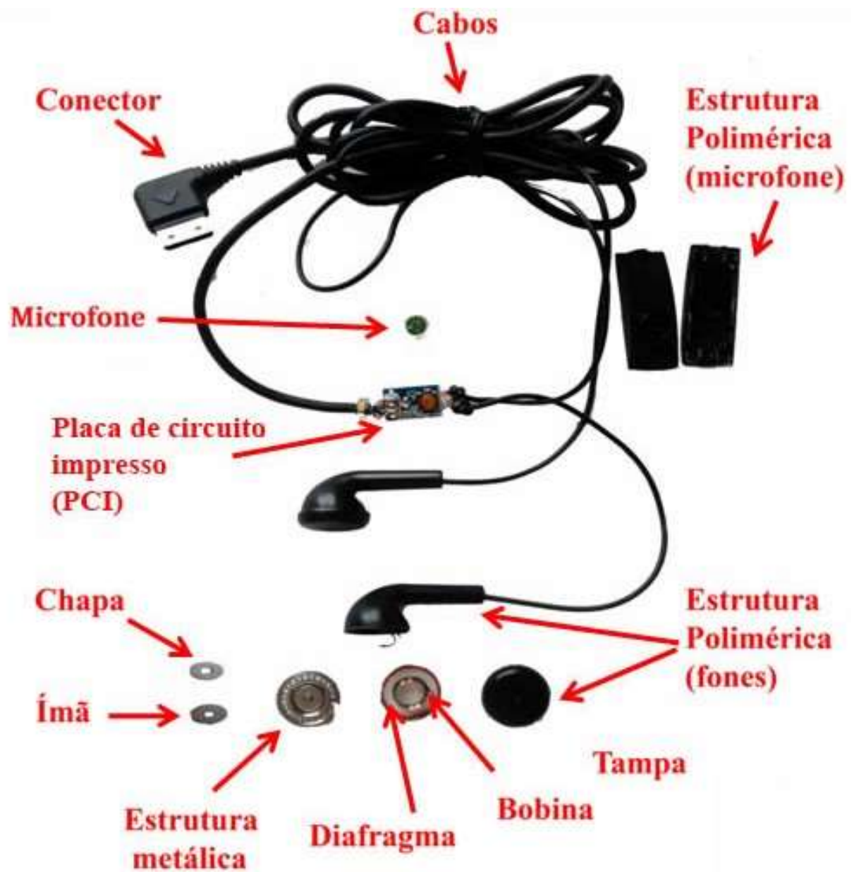
Figura 3 - Fone de ouvido desmontado com indicação dos principais componentes (Fonte: Autor)
