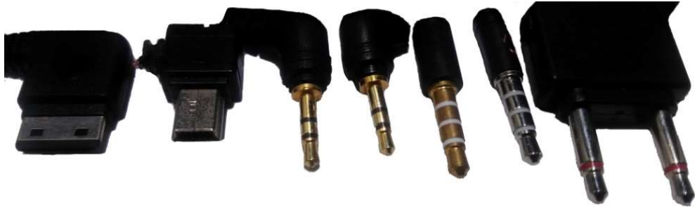
Figura 16 – Conectores de diferentes marcas e modelos analisados por FRX. Pode-se verificar diferentes geometrias de conexões e revestimentos de cor dourada e prateada, indicando diferentes materiais para o revestimento. Fonte: Autor
