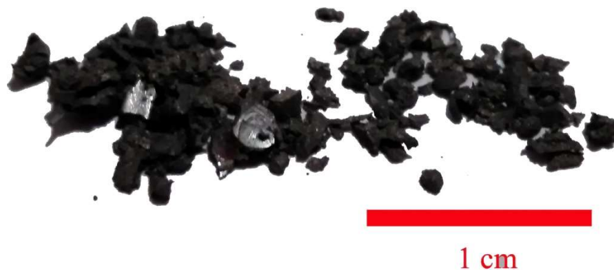
Figura 28 - Amostra de fone do tipo externo decrepitada por hidrogênio (2h, 170°C, 8 bar)
