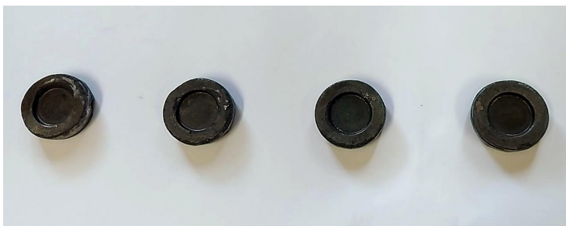
Figura 22 – Peças sinterforjadas de aço ABNT 1045.
