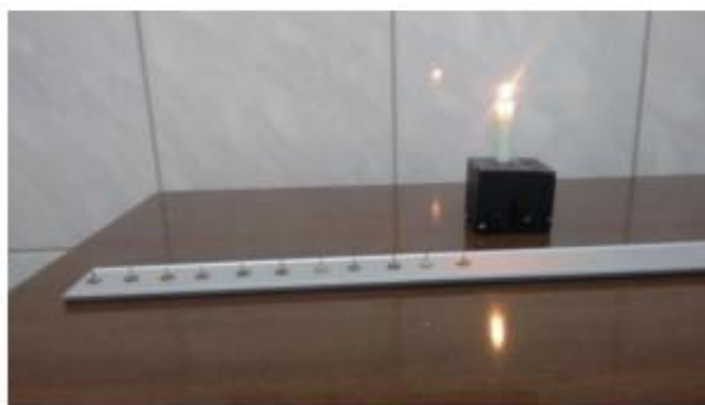
Figura 2: Montagem do experimento de propagação através da condução Fonte: (BRAGA; CARVALHO, 2021, p. 159)
