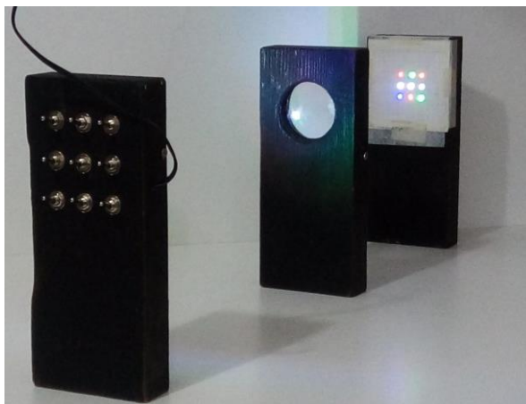
Figura 3: montagem experimental. À esquerda vê-se a parte traseira do iluminador; ao meio, uma lente convergente presa a um suporte e à direita a imagem produzida em um anteparo.
