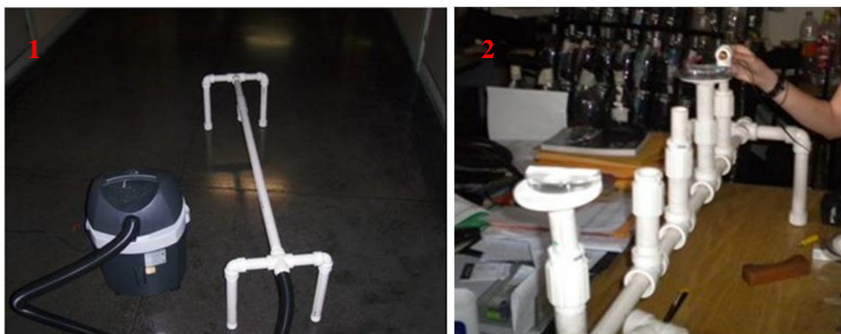
Figura 3: Dois aparatos experimentais montados utilizando canos de PVC.
