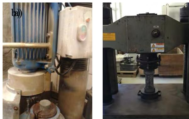
Figura 3: a) retificação dos CP's b) ensaio de resistência à compressão axial
