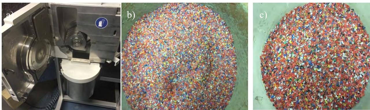
Figura 1: a) moinho de facas b) PP moído de 1 mm c) PP moído de 4 mm
