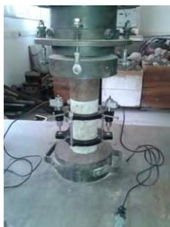
Figura 4: Instrumentação do CP para o ensaio de módulo estático de elasticidade
