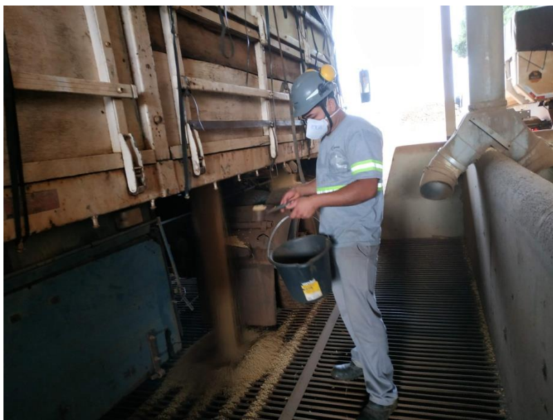
Figura 5 - Caminhão descarregando em moega e sendo coletada amostra de um dos pontos da umidade dois.
