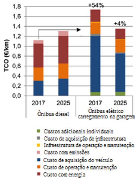
Figura 21 – Perspectiva atual e futura (2025) para o TCO de ônibus diesel e elétrico
